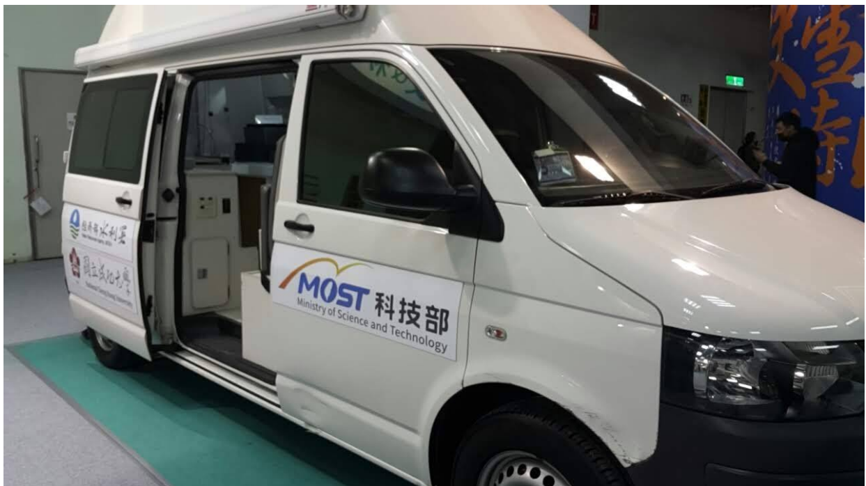
成大將相關儀器與設備放置於移動監測車，並在全台29座水庫巡迴檢測。(成大提供)
